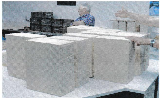
*Blocs de mousse servant lors des essais de résistance des gilets pare-balles.*
