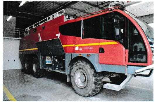
Le véhicule d'intervention dispose d'une cuve de 9 000 litres d'eau et de 250 kilos de poudre d'extinction.
